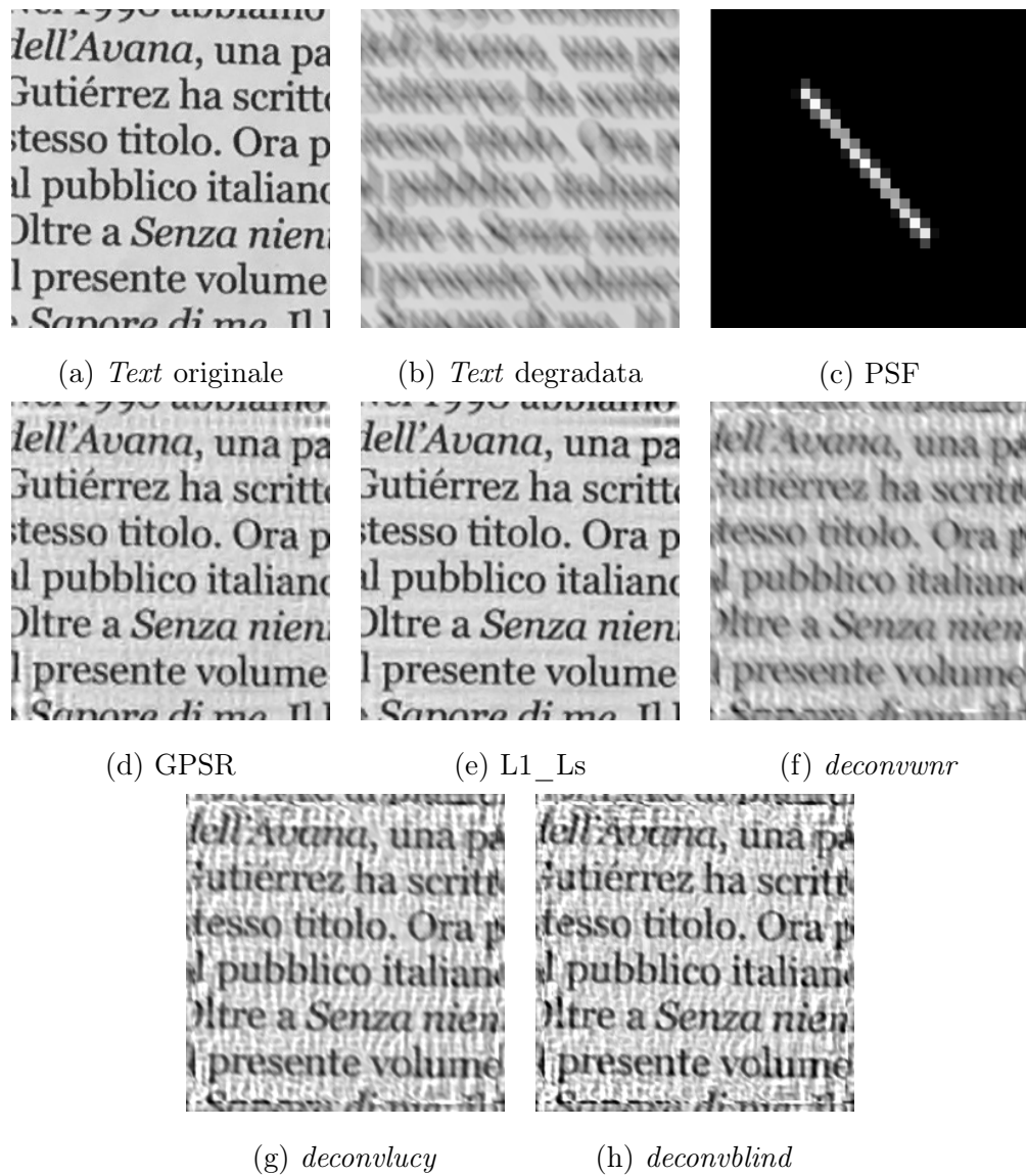
Figura 4.1: Immagine Text degradata con L = 20 e \theta = 130^\circ e le ricostruzioni con il metodo implementato (d)(e) e i metodi classici (f)(g)(h)
